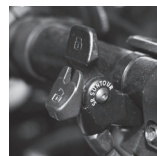
DŹWIGNIA BLOKADY SKOKU MONTOWANA NA KIEROWNICY
